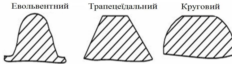
Рисунок 65 – Профілі зуба зубчастих передач
